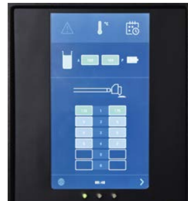
Gemakkelijk te programmeren bedieningsoppervlak met 7" touchscreen
